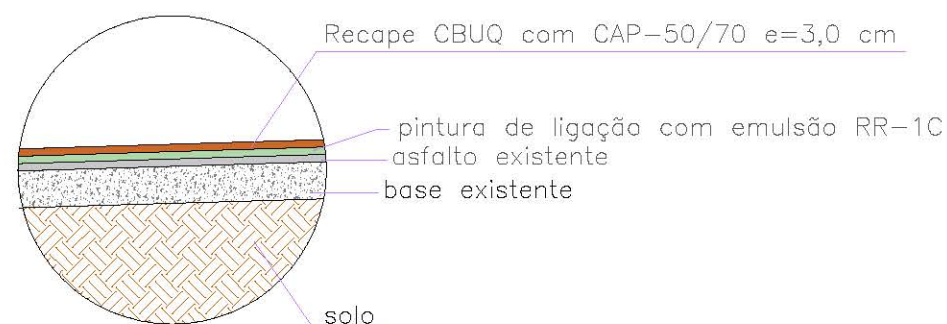
DETALHE 01 - CORTE RECAPE PAVIMENTAÇÃO
